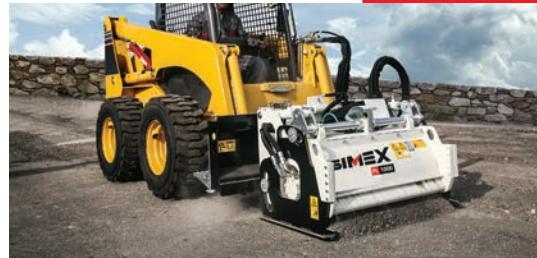
Le fresatrici stradali autolivellanti Simex PL sono **progettate per rimuovere l'intero strato di asfalto o cemento** in preparazione di un successivo scavo, o per la **scarifica della superficie ammalorata** per il conseguente ripristino. Create per **fresare sezioni predefinite** su superfici dure e compatte, permettono di riutilizzare il materiale scarificato per il successivo riempimento dello scavo.
